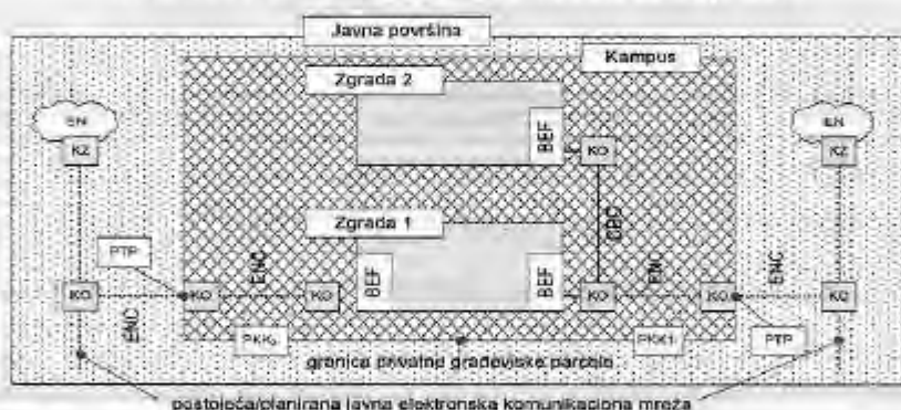
Слика 1 - Пример приступне кабловске канализације
